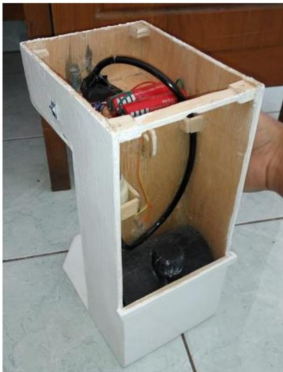
Gambar 5. Susunan komponen pada alat Handsanitizer
