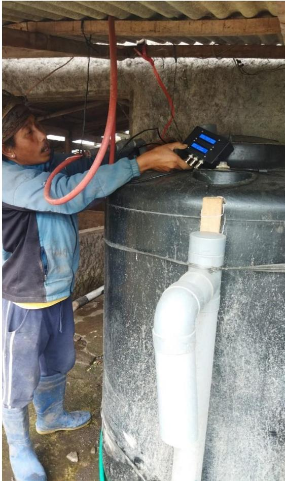
Gambar 6 Pengukuran Volume biogas yang dihasilkan oleh Bioreaktor
