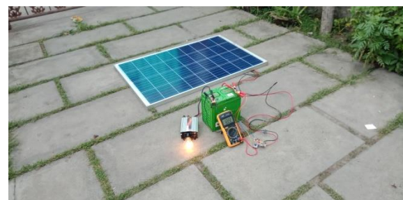
Gambar 4. Pengujian inverter 500 W dan beban lampu pijar 100 watt.
