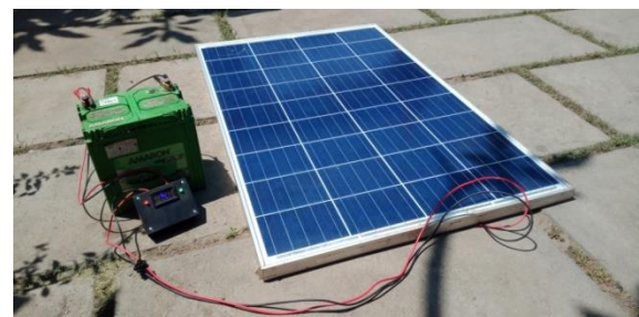
Gambar 3. Pengujian penyimpanan energi listrik dari panel surya ke baterai
